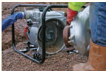
Der abnehmbare Inspektionsdeckel ermöglicht einen leichten Zugang
